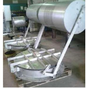
VOCE DI CAPITOLATO : fornitura di valvola antiriflusso a galleggiante in acciaio .....(AISI 304 – AISI 316 – acciaio zincato) a sezione circolare o rettangolare delle misure di ..... mm ; guarnizioni in EPDM ; le valvole devono essere costruite per impedire il riflusso dell'acqua a seguito dell'innalzamento del livello grazie alla spinta del liquido sul galleggiante
