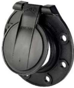
VOCE DI CAPITOLATO : Fornitura di valvola antiriflusso fine linea a battente verticale costruita in poliammide , per accoppiamento a parete verticale o a flangia forata PN10; tenuta idraulica 1 bar; guarnizione di tenuta in EPDM
