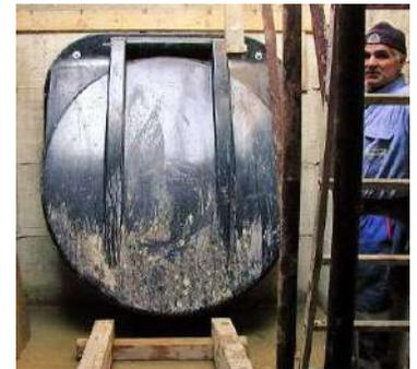
VOCE DI CAPITOLATO : Fornitura di valvola antiriflusso fine linea costruita in poliestere rinforzato e gel-cot isoftalico, metallerie in acciaio inox AISI 316 , flangiata per accoppiamento a parete verticale ; battente inclinato ; tenuta idraulica 1 bar ; guarnizione di tenuta in EPDM
