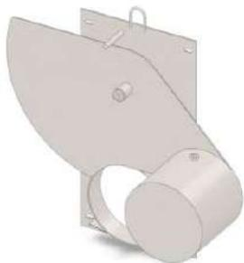
Valvola regolatrice della portata in acciaio inox AISI304 per una corretta gestione delle reti idriche unitarie o separate. Si applica a valle di bacini di ritenzione, sbarramenti, strutture idrauliche in genere. Campo di lavoro da 5 a 800 l/sec. con altezza dell'acqua da 0,37 a 2,23m. La chiusura progressiva dell'orificio di scarico all'aumentare del livello consente di mantenere costante la portata a valle. La portata viene regolata in stabilimento
