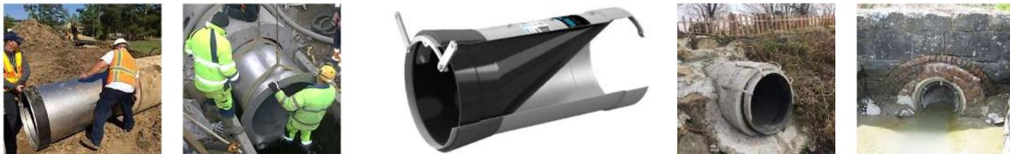
VOCE DI CAPITOLATO : Fornitura di valvola antiriflusso WS in gomma del tipo azionato dal fluido da inserire all'interno di una condotta avente Di..... mm ; corpo flessibile deve essere costruito in un unico pezzo di gomma contenuto all'interno di un guscio in acciaio inox AISI 304. Tenuta idraulica membrana standard S3 con 5m H2O
